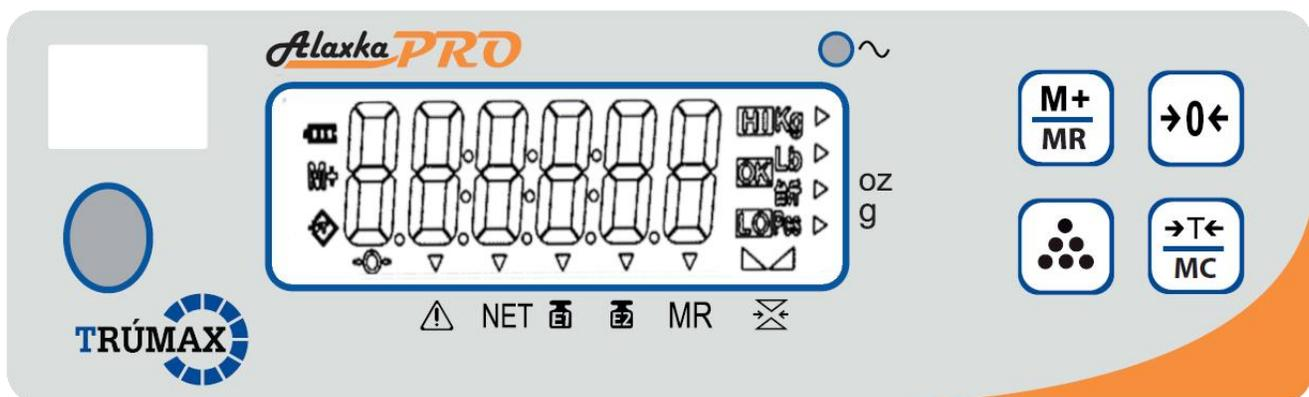
Indicador de nivel de batería: Hay 3 bloques llenos en el indicador. Cuando el voltaje de la batería es inferior a 5.5v, los bloques de la batería comenzaran a disminuir.
