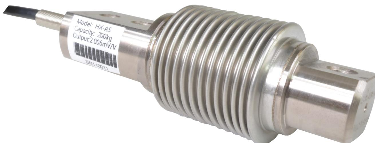
Celda de carga tipo fuelle para plataformas de bajo perfil, clase C3, sensibilidad de 2mV/V, protección IP67, fabricada en aleación de acero, utilizada en basculas tipo tanque, riel, tolvas silos; impedancias características: 385 ohm entrada y 351 ohm salida. Capacidad disponibles 100kg.
