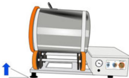
Fig. 6 AJUSTE CONTRA DESPLAZAMIENTO
