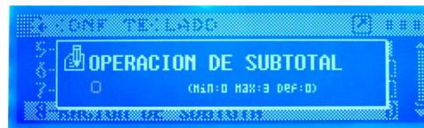
Pantalla de ajuste numérico. Se indica el valor mínimo, máximo y por defecto.
